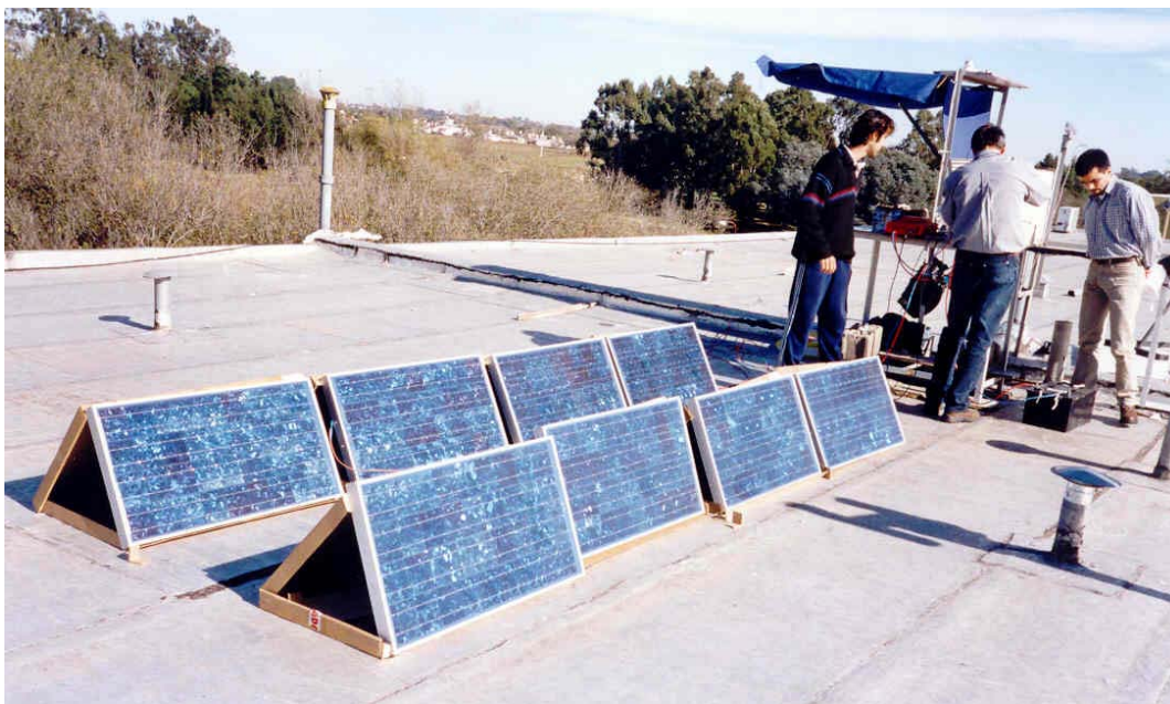
Figura II.3: Preparación de los módulos para que establezcan su temperatura antes del ensayo de características eléctricas.
