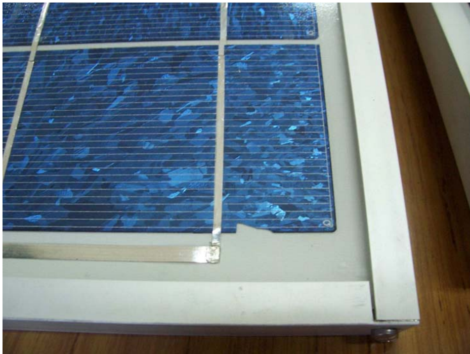
Figura II.9: Ensayo de inspección visual. Celda defectuosa. La falta de material en la celda no presenta una disminución apreciable de las características tensión corriente.
