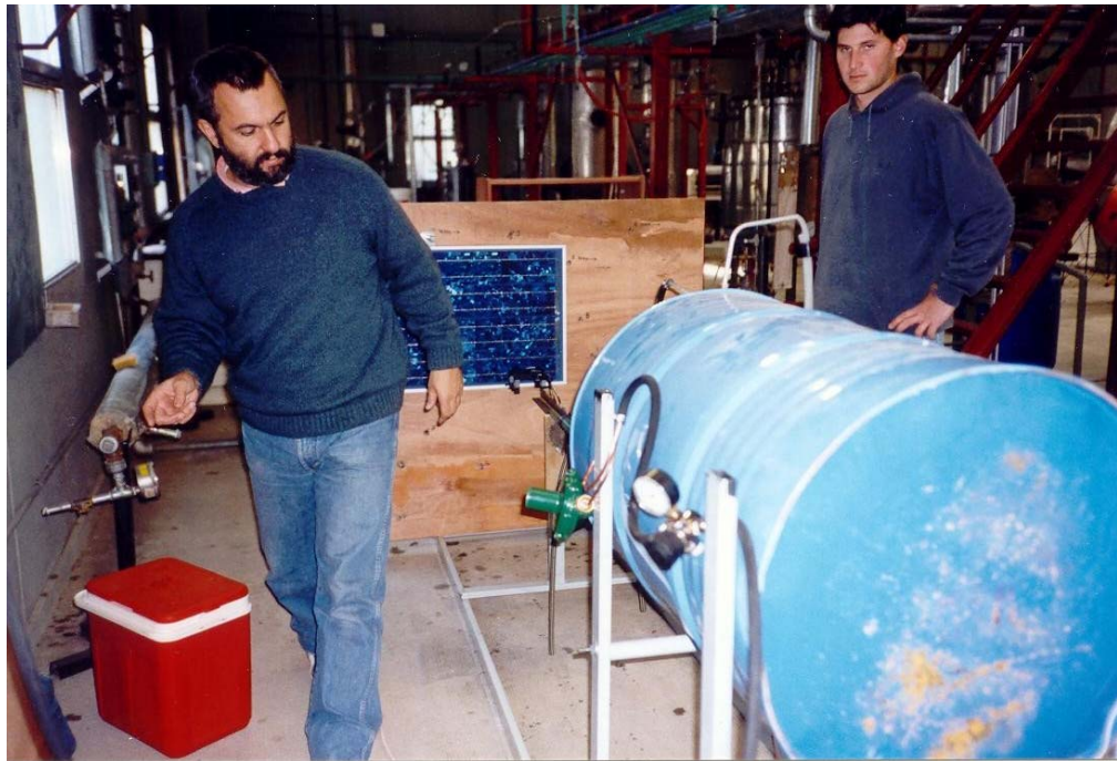
Figura II.5: Máquina desarrollada en el GES para la realización del ensayo de resistencia al impacto de granizo. Se puede observar el regulador de presión del reservorio de aire comprimido.
