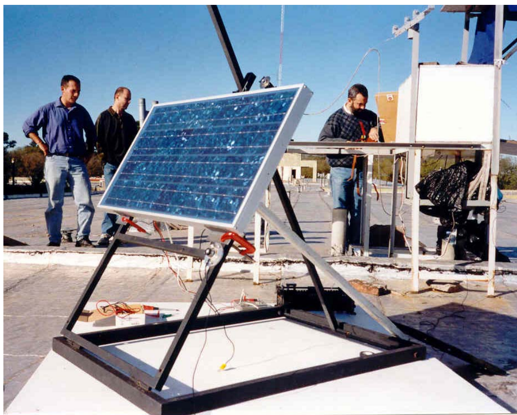
Figura II.1: Medición de característica I-V en un módulo fotovoltaico de silicio policristalino. Se puede observar que el soporte para orientar correctamente el módulo también contiene en forma coplanar un solarímetro fotovoltaico, que en esta ocasión se adoptó como reemplazo de la celda solar de referencia.
