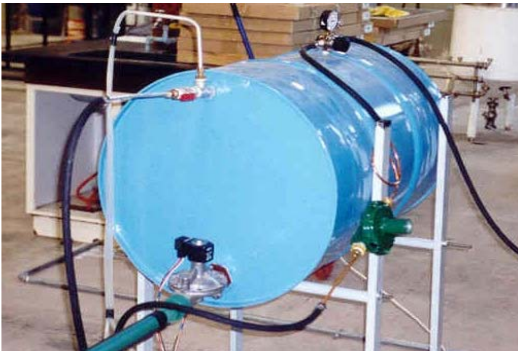
Figura II.7: Máquina desarrollada en el GES para la realización del ensayo de resistencia al impacto de granizo. Se puede observar el dispositivo la electroválvula de apertura rápida .
