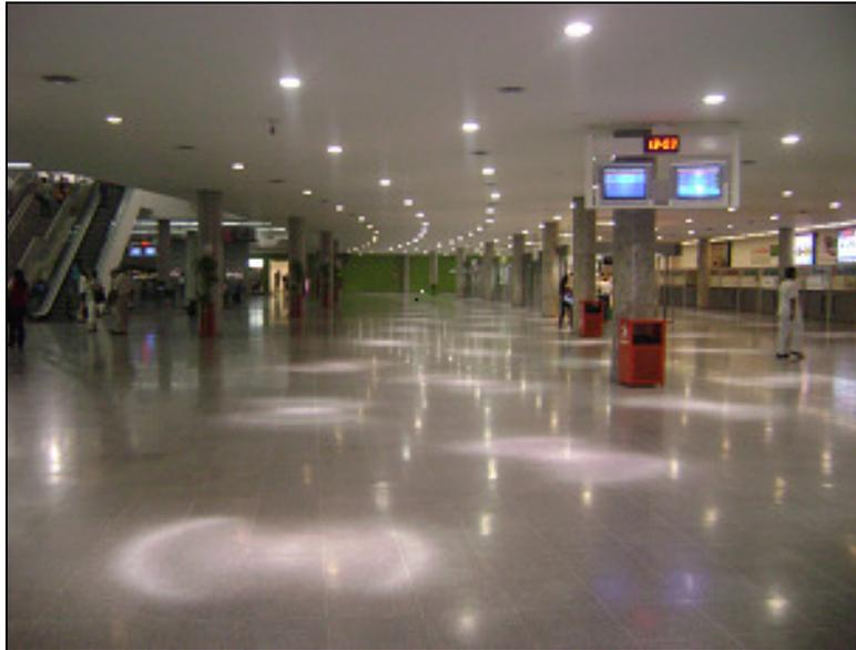
Figura 4.14- Hall de acceso al Edificio Se aprecia los excesivos niveles de Iluminancia Horizontal con baja regularidad, y bajos niveles en Iluminancia vertical. Fotografía tomada el 15/02/2.009-
