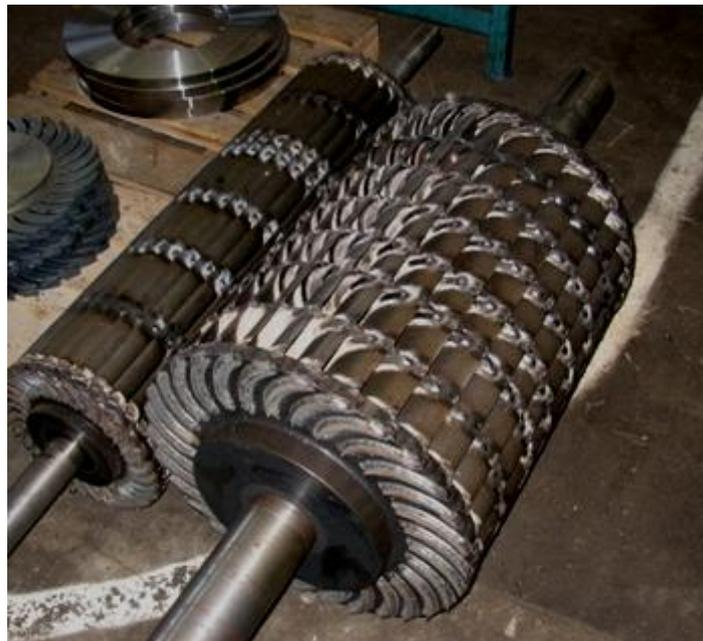
Fotografía N.18. Detalle de una turbina banki para producción hidroeléctrica.
