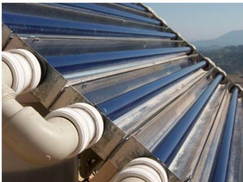
Fotografía N.14. Reactor fotocatalítico. Fuente:
