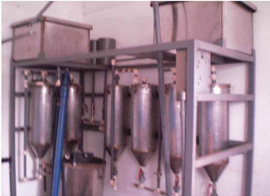
Fotografía N.16. Planta de tratamiento experimental utilizando filtros con zeolita, Universidad Nacional UNA. Fotografía A. Hidalgo. 2012
