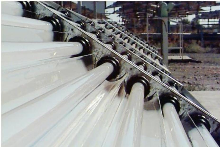
Fotografía N.19. Detalle de un colector cilíndrico parabólico compuesto CPC
