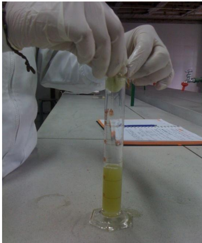
Foto 14. Filtración del jugo extraído por licuado y molido, en ocho (8) capas de gasa quirúrgica
