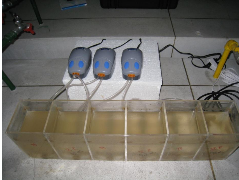
Foto 9. Celdas de reactores SBR 3 adaptados. Pruebas de capacidad del zumo del fique como agente secuestrante de compuestos amoniacales para la disrupción del proceso de nitrificación
