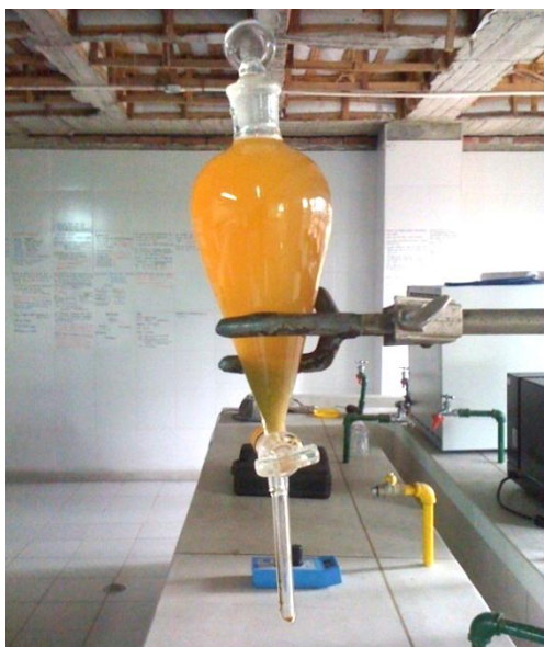
Foto 16. Zumo de fique fermentado. El decantado (marrón verdoso oscuro) tiene las geninas decantadas en forma de mono y di-glicósidos; el sobrenadante (amarillo verdoso claro) es en su mayoría agua y ácidos grasos
