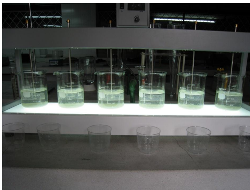
Foto 17. Pruebas de tratabilidad con aguas residuales de pastelería y repostería. Fase de sedimentación
