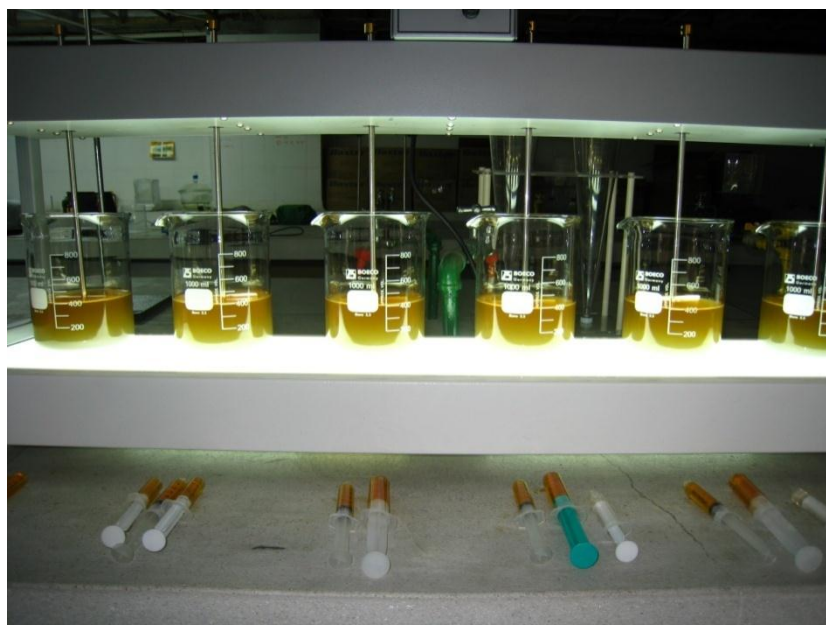
Foto 8. Equipo de Prueba de Jarras (Jar-Test). Pruebas de tratabilidad para el uso del zumo del fique como coadyuvante de coagulación
