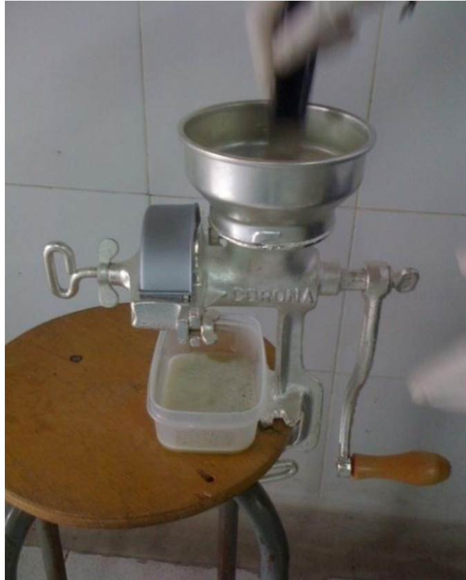
Foto 13. Molido del bagazo producto del licuado de la hoja de figue
