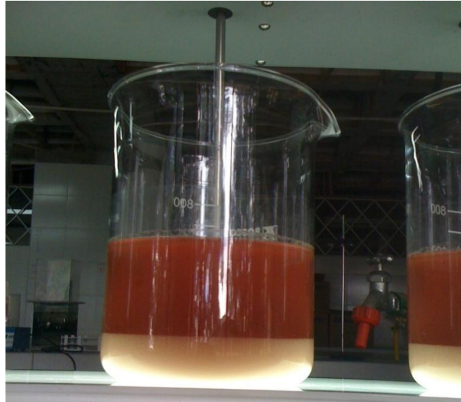
Foto 20. Aguas residuales de industria de productos cárnicos y embutidos en fase de sedimentación, durante la prueba de tratabilidad
