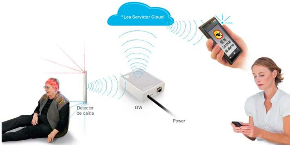
Se trata de una solución compuesta por dos unidades sensoras con comunicación inalámbrica integradas en un único dispositivo. Dispone de feedback acústico / luminoso, batería y no necesita almacenamiento de patrones. El modo de instalación es muy sencillo, ya que no necesita obras, lo que lo hace idóneo para el entorno construido.
