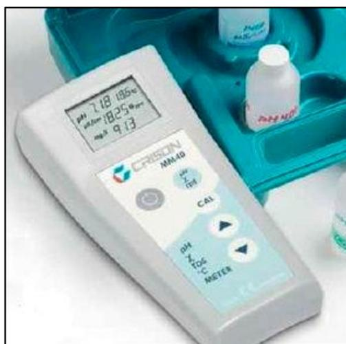
Fotografía 9. Equipo multiparamétrico utilizado, marca Crison MM-40.
