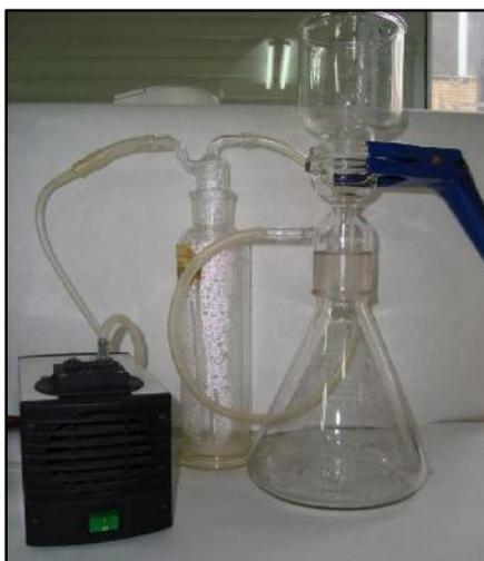
Fotografía 10. Equipo de filtrado empleado: Kitasatos y bomba de vacío.
