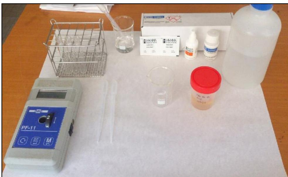
Fotografía 11. Fotómetro FP-11, Macherey-Nagel y material utilizado para preparación de muestras.
