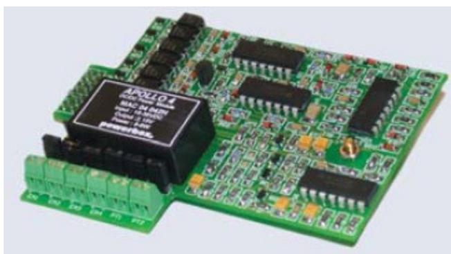
Figura 28. Tarjeta de entradas analógicas del inversor
