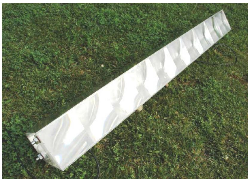
Figura 36. Módulo M40, formado por 10 células de triple unión.
