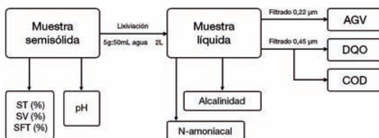
Fig 15. Diagrama del procedimiento analítico seguido en las muestras de efluente del residuo sólido
