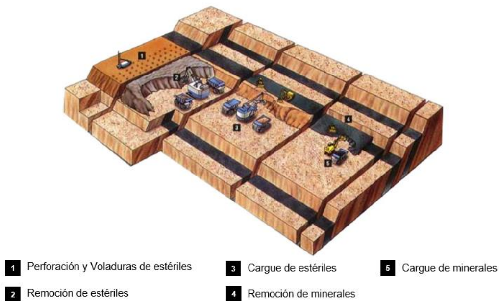
Figura 1. Secuencia típica de trabajo en una mina a cielo abierto. Fuente: (Carrillo Montero & González Valle, 2008)
