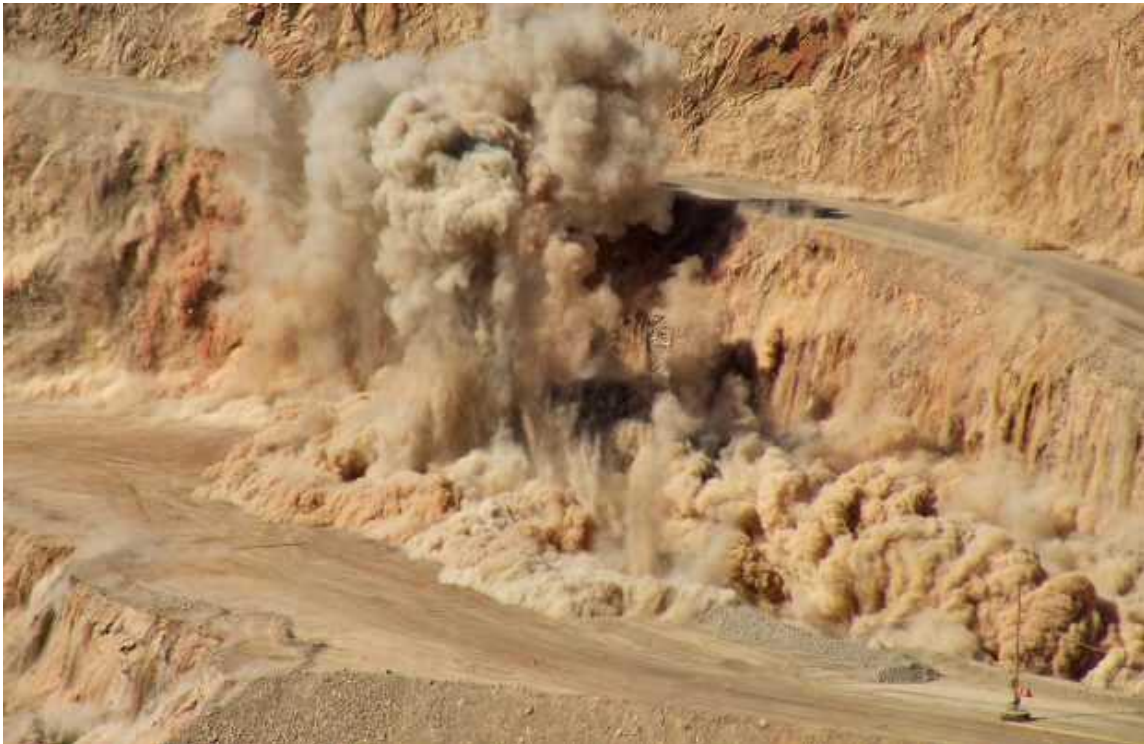
Figura 3. Emisiones de polvo producto a tronaduras en una mina a cielo abierto. Fuente: (Burgada, 2018)
