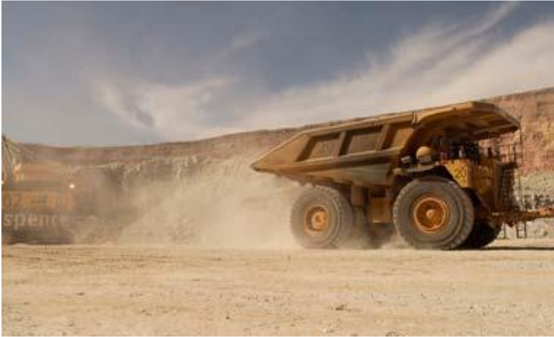
Figura 2. Polvo generado por un camión minero durante el transporte de materiales en vías no pavimentadas. Fuente: (Arellano & Albert, 2017)
