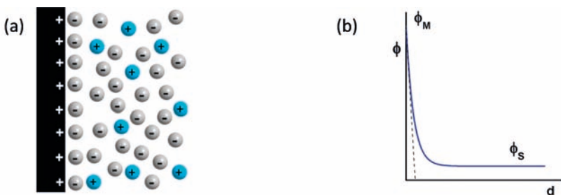
Figura 9. Modelo de Stern y variación del potencial eléctrico con la distancia al electrodo.
