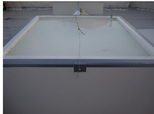
Figura 3-39. Ubicación del sensor Tw2.
