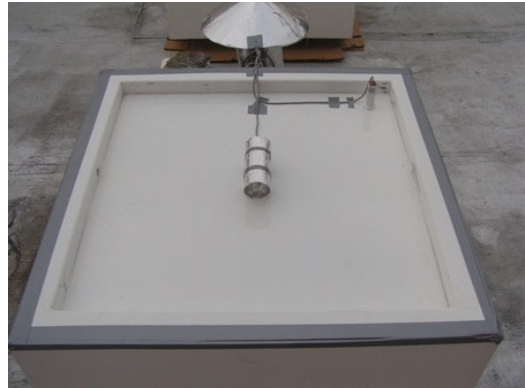
Figura 3-27. Ubicación de sensores de medición.
