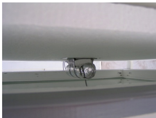
Figura 3-22. Sensor de medición de Toe.
