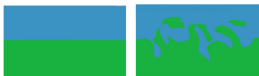
Ilustración 3: A la izquierda estructura bicapa, a la derecha bulk heterojunction.
