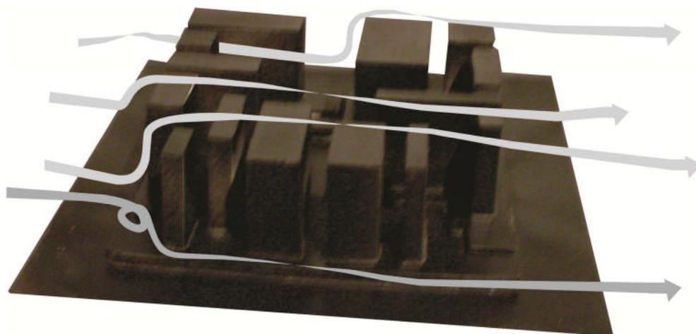
**Gráfico 79:** Representación del movimiento del aire, ensayado en túnel de viento de baja velocidad en CIHE.
