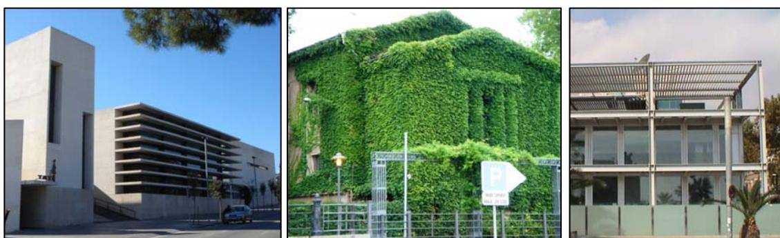
Figura 6. Sistemas de protección solar: celosías, vegetación y pérgolas
