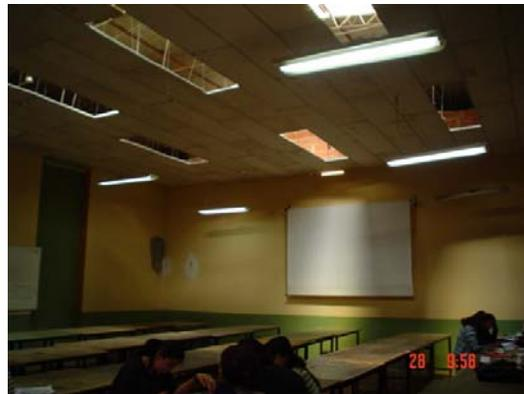
Así mismo se observó espacios en los cuales la iluminación tanto natural como artificial es ineficiente provocando contrastes y deslumbramiento lo que llega a provocar fatiga visual, esto interfiere con el rendimiento dentro del aula, provocando una tardanza para que el ojo se ajuste a estos cambios de luz dentro del ambiente.
