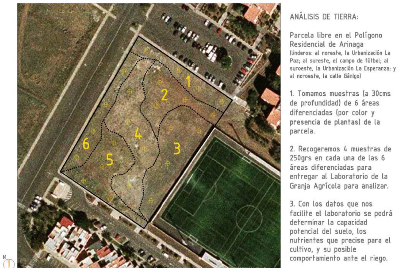
Imagen 48: Pasos que se siguieron en la recogida de muestras de terreno para el envío al laboratorio.
