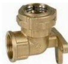
Figura 63: Racor L, tipo codo H pared, preparado para tubo de polietileno de alta densidad, de 25 mm de diámetro exterior a grifo de 3/4", s/UNE-EN 12.165.
