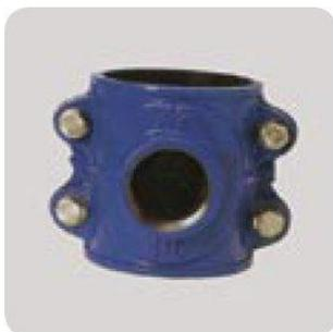
Figura 62: Collarín de derivación para la toma de agua, que nos permite derivar de 90 mm (tubería procedente del depósito) a 25 mm (tubería con válvula de esfera y grifo para cada punto de toma de agua)
