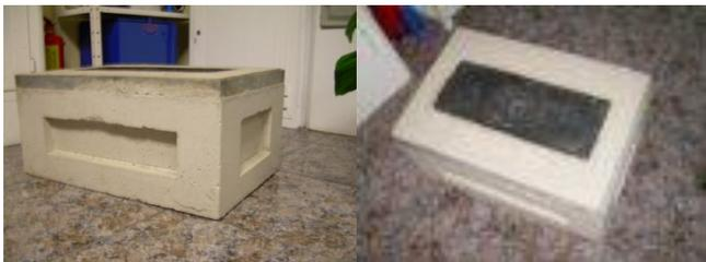
Figura 100: Arqueta prefabricada marca Munasa, con tapa de fundición, para alojamiento de contador de agua (61x41x29 cm de LxAxP)
