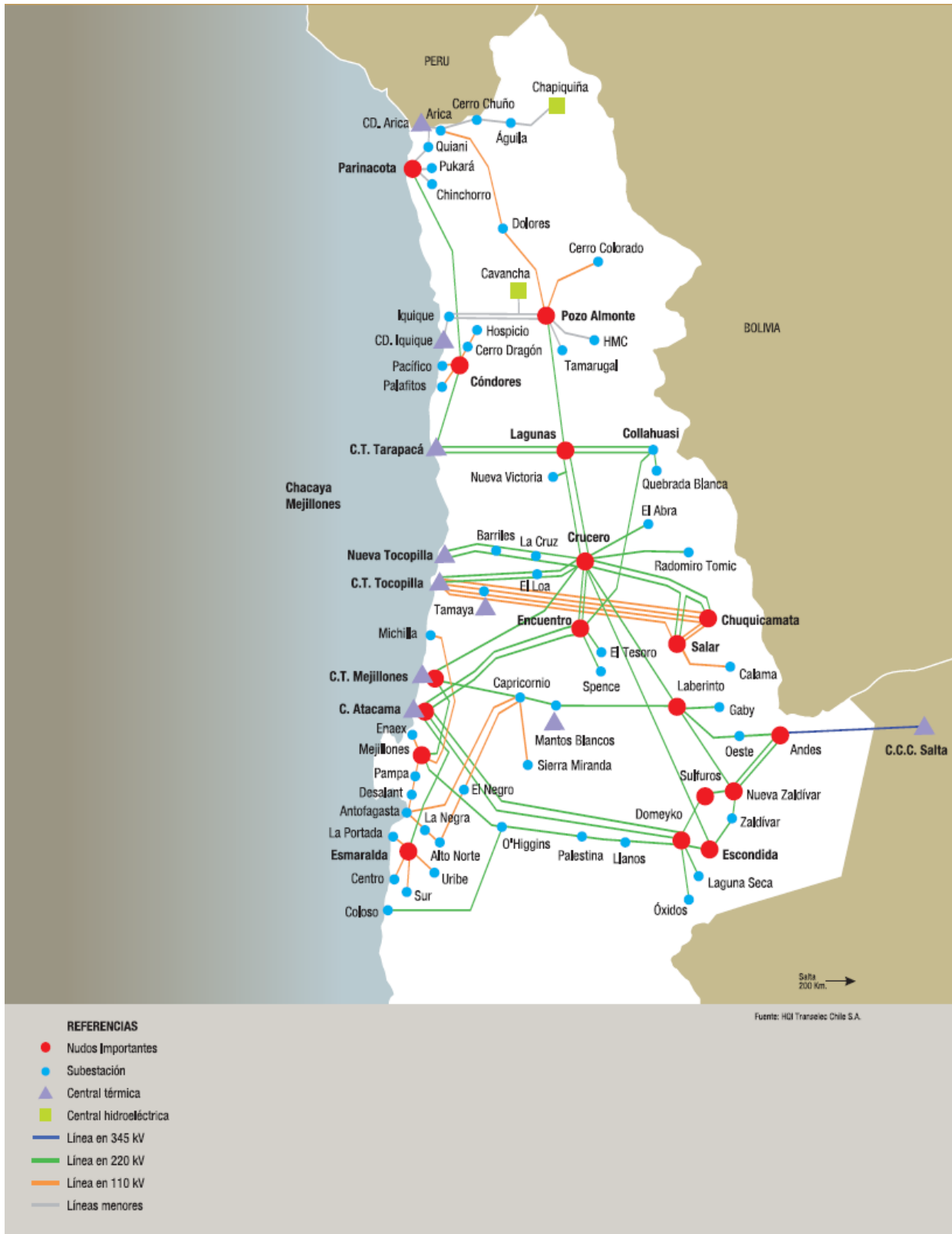
Figura 9: sistema interconectado norte Grande
