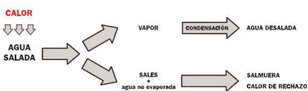
*Figura 1.1. Esquema desalinización vía térmica*
