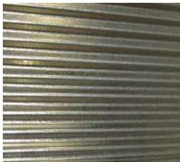
La lamina de **zinc corrugada**, utilizada para la cubierta de los puestos de venta, es un material bastante económico y tiene varias cualidades que le hacen especialmente adecuado para revestir cubiertas
