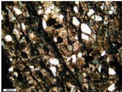
*FOTO 17: Imagen de microscopía petrográfica (nicoles cruzados) de desplazado, con fisuras perpendiculares a la superficie expuesta del sillar. Escala: 200 µm.*
