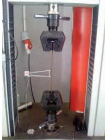
FOTO 3. Fuente: Elaboración propia; Nota al pie: Maquinaria empleada para los ensayos de compresión de las muestras cerámicas.
