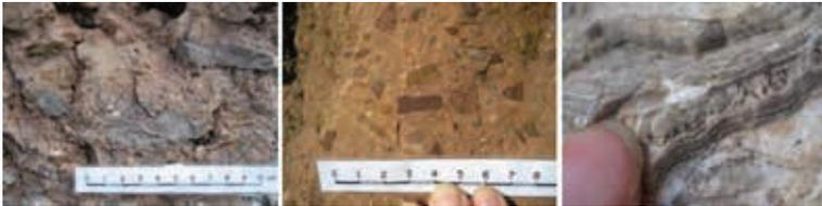
*Fig.1.1.15.. Detalle de mampuesto (brecha)*
