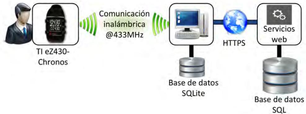
*Imagen 7. Prototipo de arquitectura para la monitorización.*
