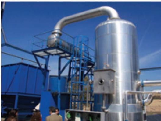
Figura 3.15. Sistema de depuración de lixiviados.
