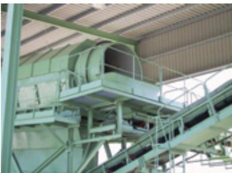
Figura 3.3. Detalle de Tromel de separación.
