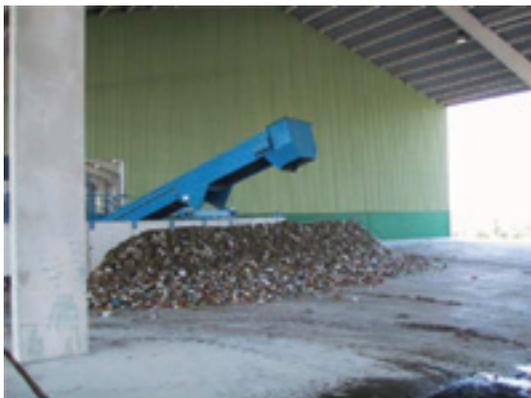
Figura 3.7. Aspecto que tiene la cinta formadora de pilas o montones de compost.
