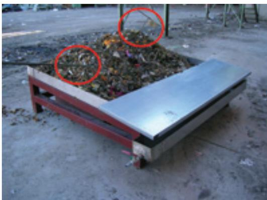
Figura 3.16. Planta piloto cargada con residuo fresco. En la parte superior izquierda y derecha se observan las sondas de temperatura.
