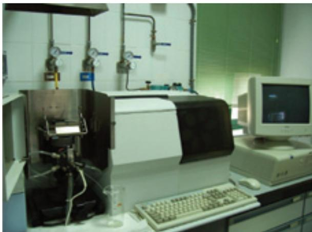
Figura 3.39. Espectrofotómetro de llama AAnalyst 300.
