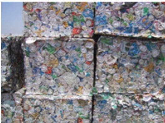
Figura 3.6. Las latas separadas mediante corrientes de Foucault y posteriormente prensadas.
