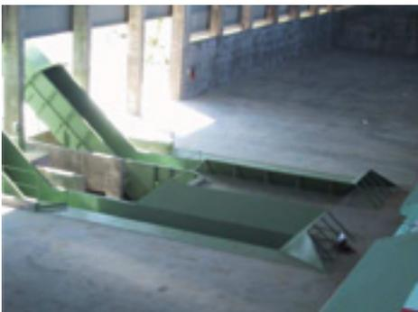
Figura 3.2. Zona de descarga. Se observan las dos cintas; línea de inertes y línea de orgánica.
