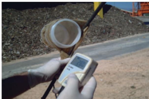
Figura 3.19. Data Logger para registro de la temperatura interior de las pilas de compostaje.
