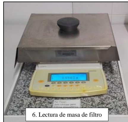
Fotografía 1: Proceso de pesaje de filtros con la balanza digital marca Sartorius
