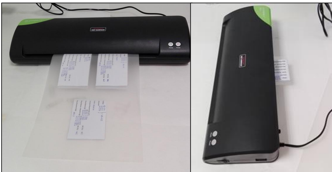
Fotografía 5: Prensado de filtros patrón con etiqueta de identificación
