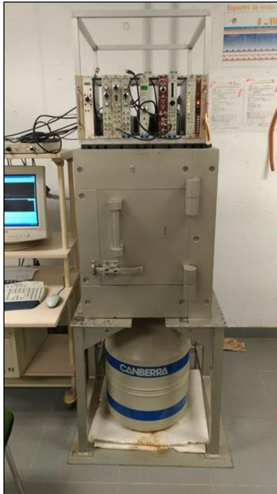
Fotografía 3: Espectrómetro gamma coaxial de germanio intrínseco, de Rango Extendido (XtRa)
