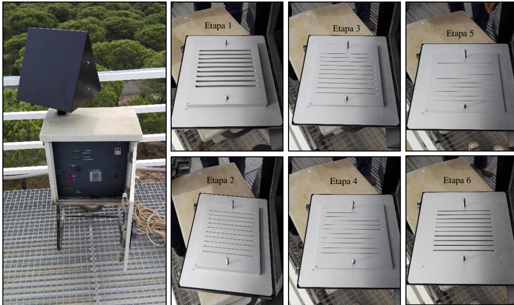
Figura 2-4: Impactor en cascada marca MCV modelo IC-CAV
