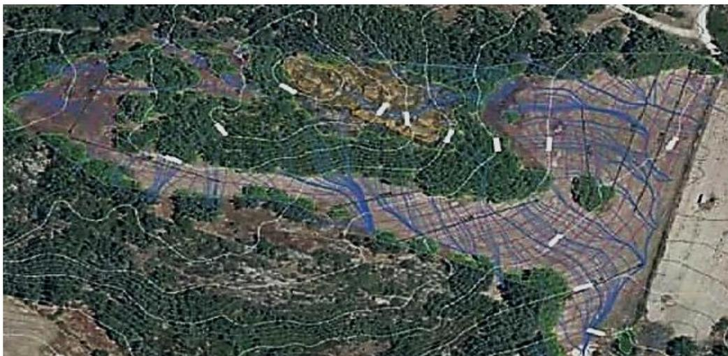
*Imagen 10 Estudio de escorrentía de la finca para poder diseñar el posicionamiento de las charcas y el estudio de las líneas clave. Fuente: Jonás Dallador*
