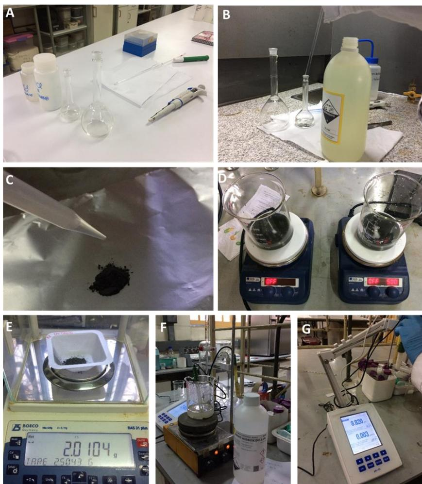
Figura 12: Ensayos químicos en Universidad de Chile. (A y B) Preparación de soluciones químicas. (C) Determinación del Fizz Rate adicionando gotitas de HCl al 25% de concentración. (D) Disposición de las pulpas sobre agitadores magnéticos. (E) Separación y pesado de 2 gramos de muestra. (F) Monitoreo del pH en cada etapa. (G) Proceso de titulación de las soluciones.
