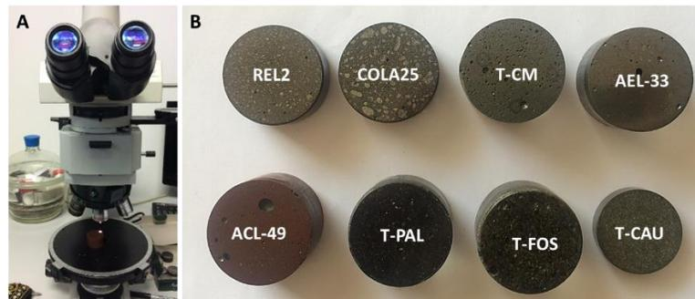
Figura 6: Microscopía óptica en UHU. (A) Microscopio *NIKON Eclipse LV 100 POL*. (B) Probetas pulidas de cada muestra.
