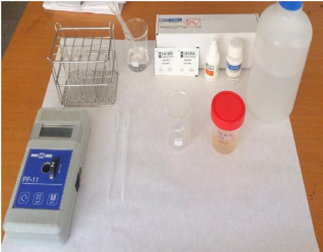
Fotografía 4. Fotómetro FP-11, Macherey-Nagel y material utilizado para la preparación de muestras.
