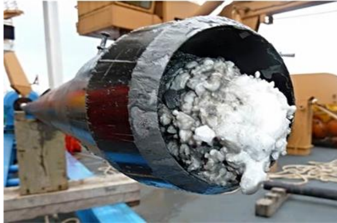
Figura 1.2. Ejemplo del taponamiento de una tubería por la formación de hidratos de gas.
