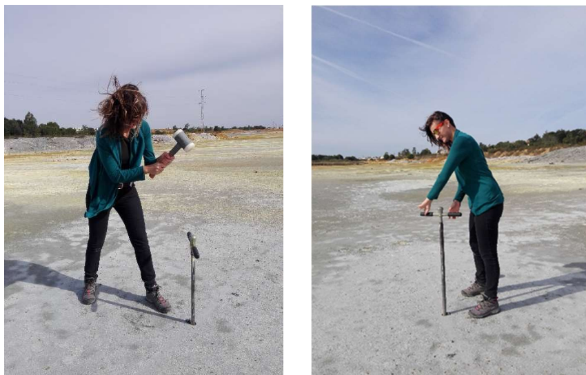
Figura 9. Perforación del suelo y extracción de la barrena para la toma de muestras.
