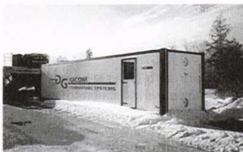
Figura 18: Túnel discontinuo móvil
