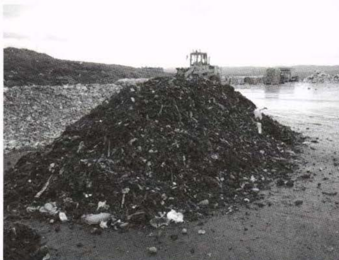
Figura 5: Pila volteada mecánicamente (windrow)
