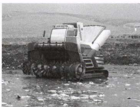
Figura 6: Pala mecánica y máquina volteadora con descarga trasera
