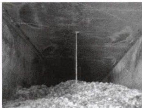
Figura 26: Sonda introducida en el material (interior túnel y vista exterior techo)
