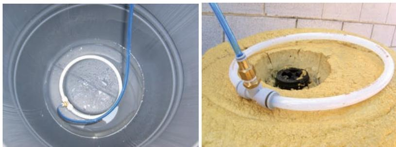
Figura 9 a-b. Sistema de aireación de los reactores.
