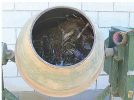
Figura 8. Mezcla del residuo en la hormigonera.
