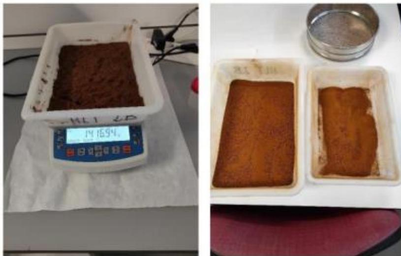
**Figura 5.** Schwertmannita húmeda (izquierda) y schwertmannita seca previamente tamizada (derecha).
