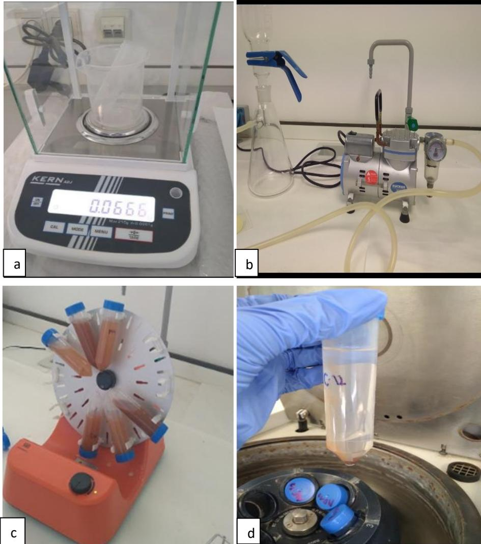
**Figura 7.** A- Imagen superior izquierda: Proceso de pesado de schwertmannita en el laboratorio. B- Imagen superior derecha: Proceso de filtrado agua de mar. B- Imagen inferior izquierda: Proceso de mezcla en la noria. C- Imagen inferior derecha: Proceso de centrifugado de la muestra.
