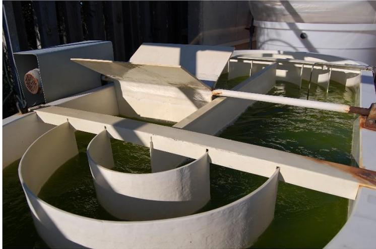
**Figura 7.5 Sistema del tipo circuito abierto agitado mecánicamente. Planta piloto experimental de CIDERTA, Universidad de Huelva.**
