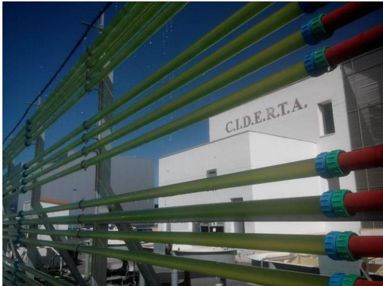
**Figura 7.6 Fotobiorreactor tubular vertical. Planta piloto experimental de CIDERTA, Universidad de Huelva.**
