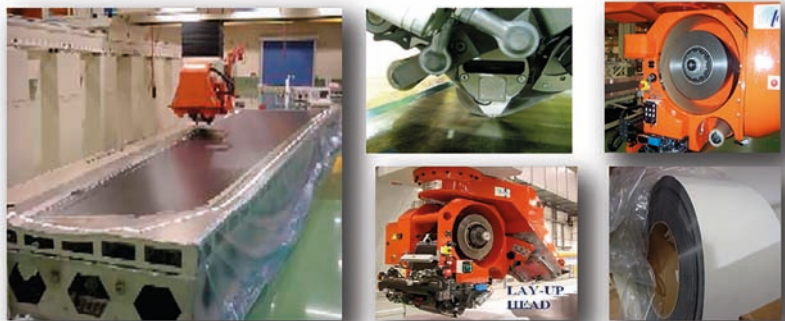
Figura 31. Fabricación automática mediante ATL.
