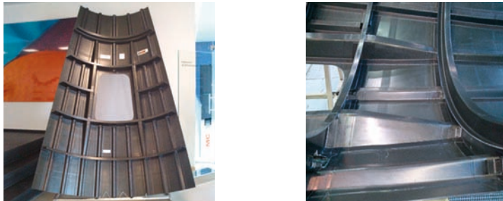
Figura 38. Estructura de fuselaje súper-integrada
