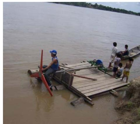
Picocentrales hidroeléctricas con turbinas de río y con sistemas de derivación y caída.
