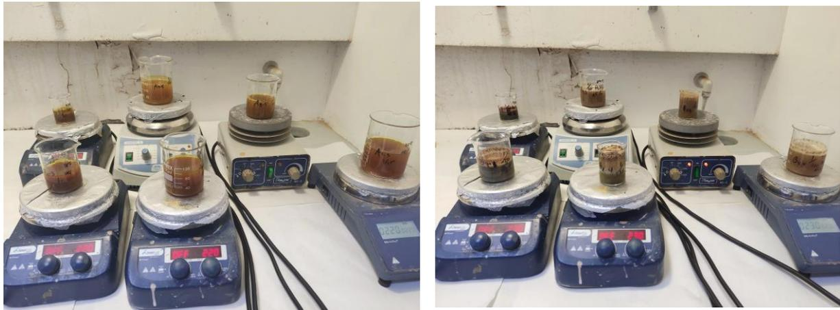
**Figura 2.3.** Lixivaciones realizadas con ácido clorhídrico (izquierda) y ácido sulfúrico (derecha).
