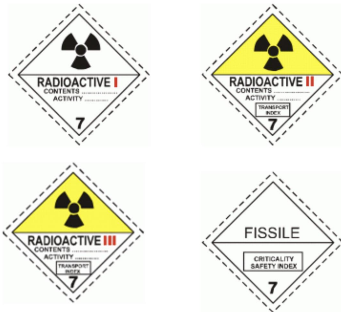
Figura 2. Etiquetas de los bultos radiactivos para el segundo supuesto. Tomada y modificada de https://aprendiendocalidadyadr.com/clasificacion-de-mercancias-peligrosas-clase-7/
