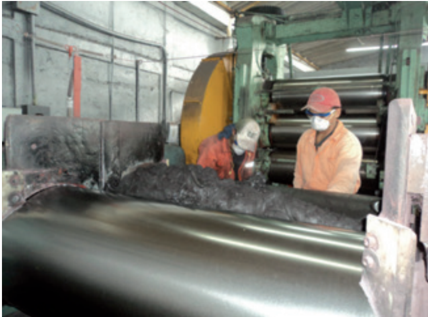
Figura 3: Laminado de látex crudo para obtención de caucho seco
