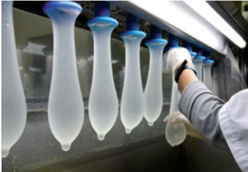
Figura 2: Prueba de resistencia de preservativos fabricados mediante el sistema de concentración del látex
