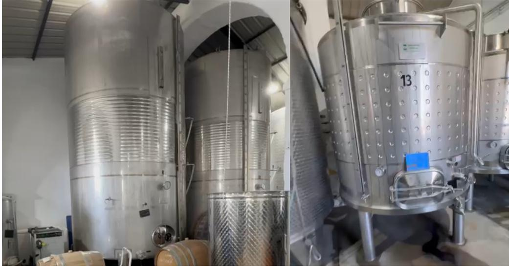
**Figura 5.6.** Tanques de fermentación de acero inoxidable con camisas de control de temperatura. Tanques para la fermentación de mosto de variedades blancas a la izquierda y de variedades tintas con hollejos a la derecha.
