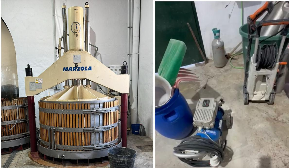
**Figura 5.5.** Prensa vertical de 25 hectolitros (izquierda) y bomba de rodete (derecha).
