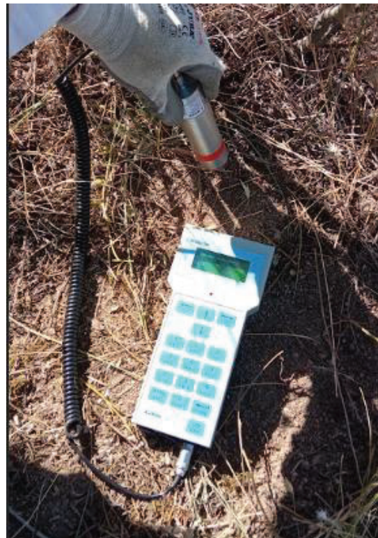
Figura 5. Medida de la tasa de dosis equivalente ambiental H^*(10) con la sonda RD2 acoplada al equipo multisonda LAMSE modelo MS6020.
