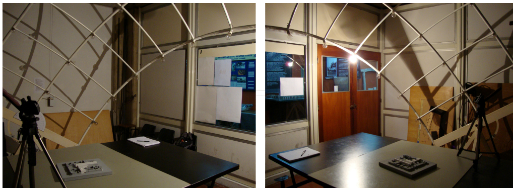
Figura VII-26 Heliodón. Estudios de Asoleamiento con maquetas. Laboratorio de Estudios Bioambientales del CIHE, FADU-UBA. Fuente: Fotografías del autor.
