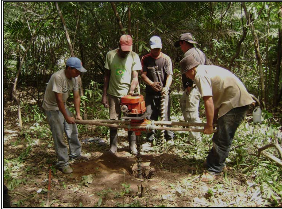
Figura No. 3-5 Técnica de perforación en áreas con espesa vegetación
