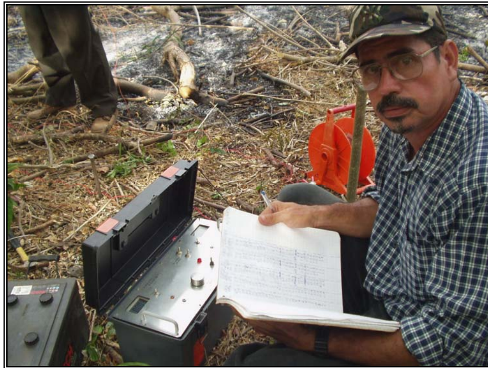
Figura No. 3-8 Toma de datos de resistividad geoelectrica (SEV), polígono "A"
