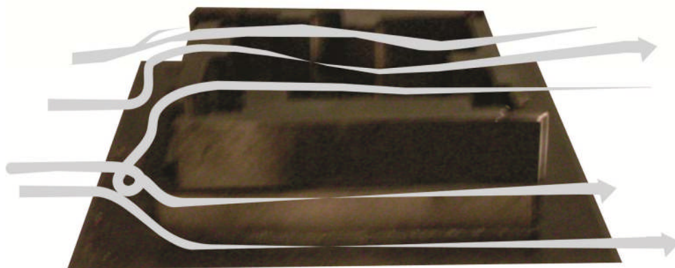
Gráfico 76: Representación del movimiento del aire, ensayado en túnel de viento de baja velocidad en CIHE.
