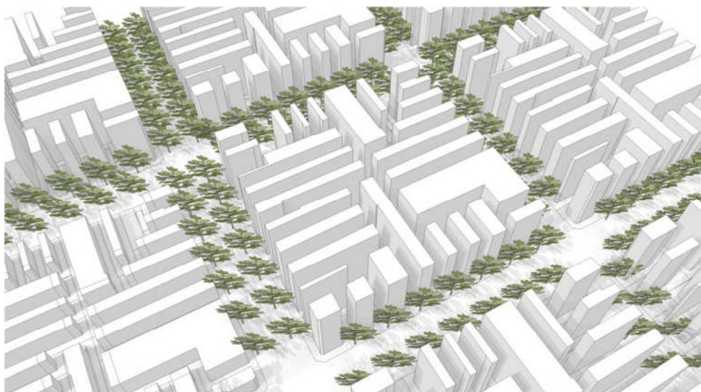
Gráfico 78: Superposición de proyecciones de sombras cada una hora entre las 10 y 16hs para el día 21 de Diciembre, solsticio de verano. Caso 4
