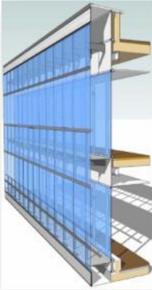
Figura XIII. 17.: Detalle Muro cortina.
