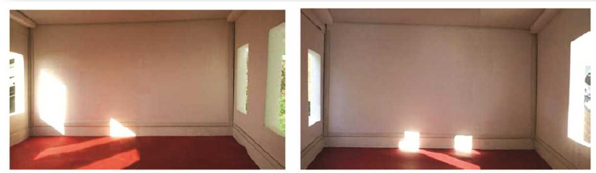
Figura XII. 24.: Prototipos base con iluminación bilateral, ventanas al Norte, cielo claro, Julio 10:00 hrs.
