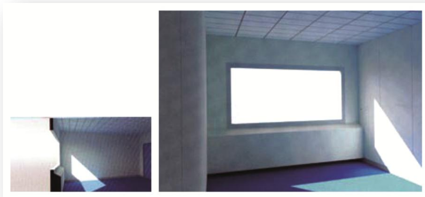
Figura XIII. 34.: La ventana sin protección de la luz directa crea demasiado contraste en el interior de la sala.
