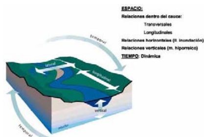
Figura 7. Componentes principales de un eje hidrográfico y relaciones transversales y longitudinales. Fuente: corredor verde del Jamuz. MIGUELES, Epifanio.
