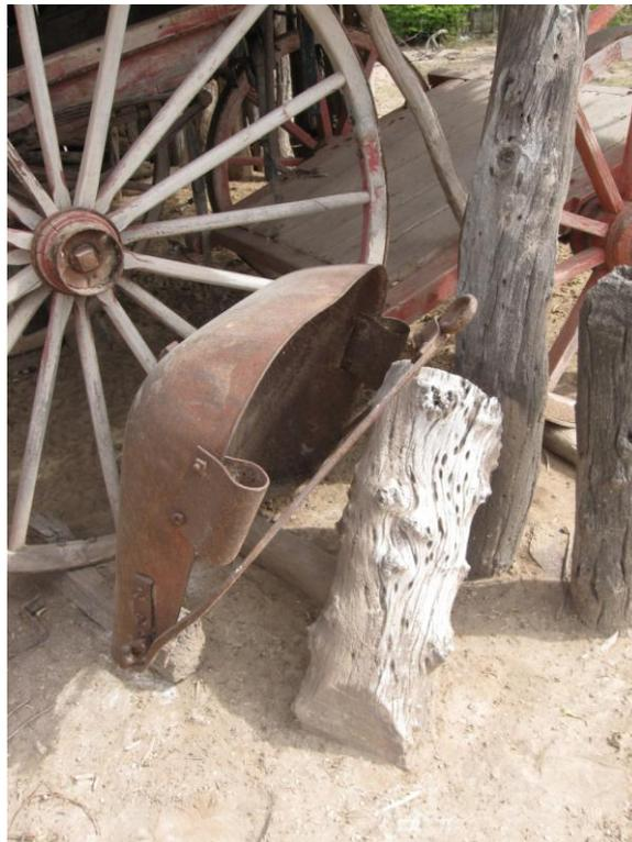
Figura 7. Pala de buey. Pala tirada por bueyes que se utilizó en las obras del Dique y el canal. Atrás, rueda de sulqui. Foto: Pablo Arístide.
