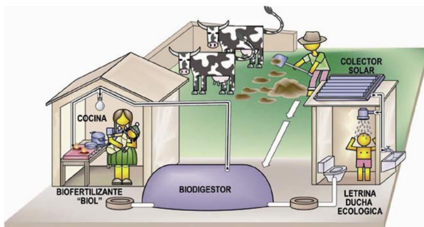
Figura 2 esquema de vivienda autoenergética
