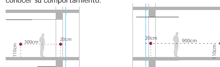
Figura 5.7: esquema en sección de localización de data logger Fuente: elaboración propia.
