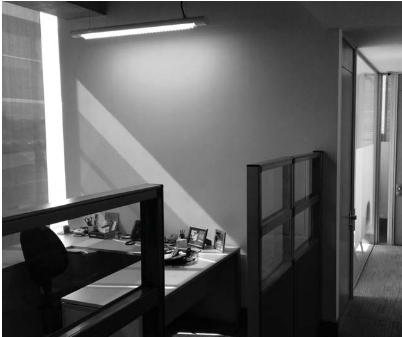
Imagen 7.2: oficina con problemas de deslumbramiento. Fuente: Elaboración propia
