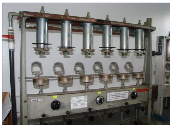
Figura 3.10. Extractor de grasas Goldfish, marca Labconco
