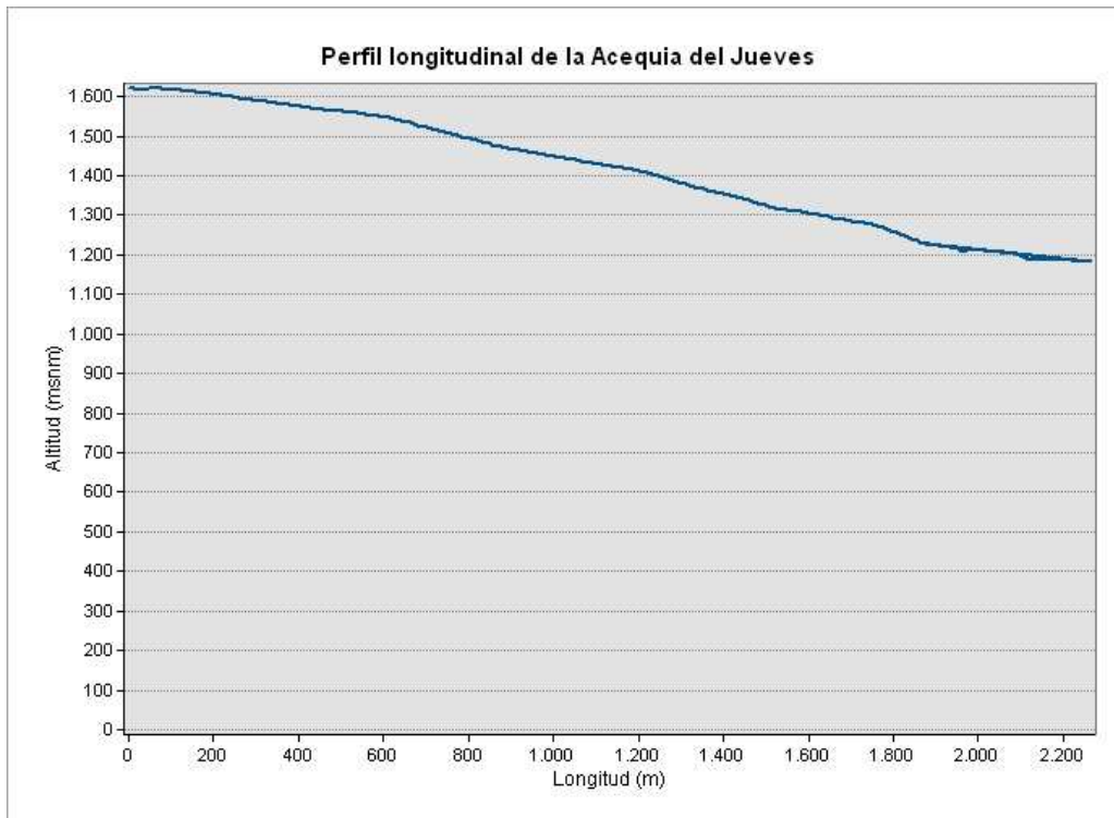
Figura 60: Perfil longitudinal de la Acequia del Jueves. Fuente elaboración propia con ArcMap
